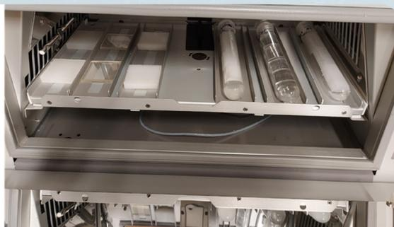
*Les différents matériaux seront vieillis artificiellement à l'aide d'une chambre d'essai Q-SUN Xenon.*
