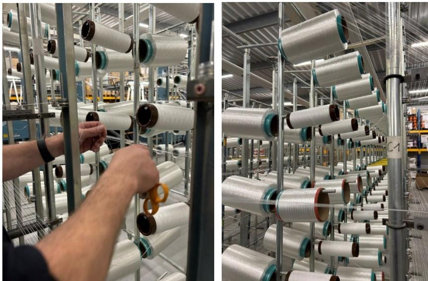
*Figure 7 : Installation des 32 bobines sur le porte-bobine de la machine à tricoter*
