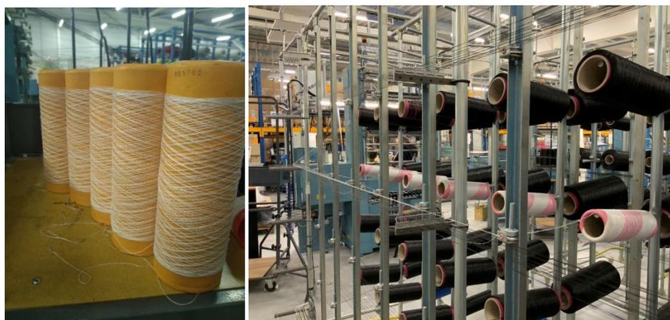
*Figure 3 : Illustration des étapes 1 et 2 avec la découpe des bobines (à gauche) et le chargement sur la machine (à droite)*
