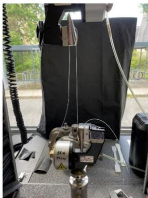
Figure 13 : monofilament installé sur la machine de traction avant le test
