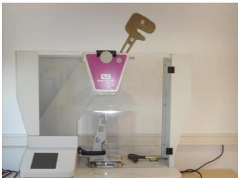
Figure 7 : Mouton pendule Impactor II
