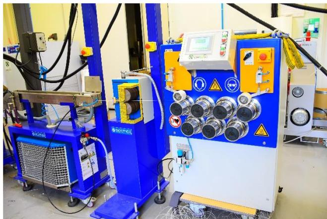
Figure 11 : ligne d'extrusion et machine d'étirage.
