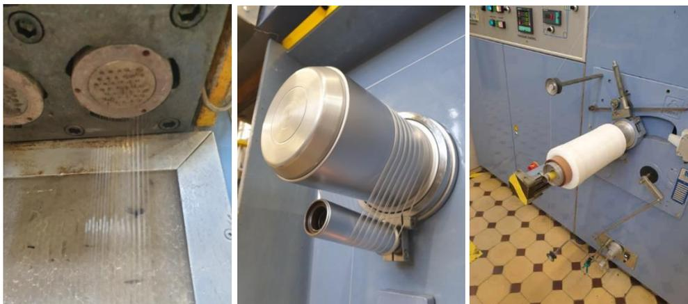
Figure 12 : Processus de transformation des multifilaments
