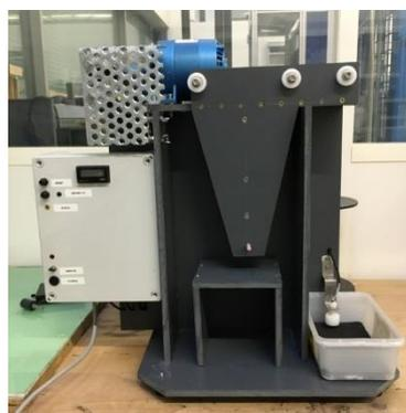
Figure 14 : Schéma correspondant à la norme ASTM où l'abrasion a lieu filament contre filament (gauche) Machine utilisée avec à la place de la poulie, une surface abrasive (droite)
