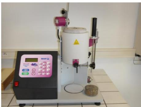
Figure 8 : appareil de MFI modulaire utilisé
